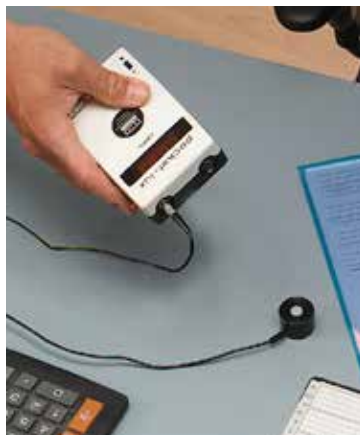
Belysningsstyrkan inom arbetsområdet och den omedelbara samt yttre omgivningen mäts med en luxmeter.
